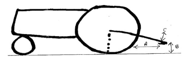
\*\*\*THE WHEELIE BAR SYSTEM MUST BE ABLE TO SUPPORT THE WEIGHT OF THE TRACTOR IN THE HEAVIEST CLASS PULLED\*\*\*
